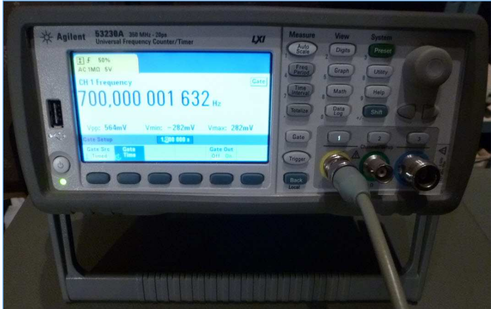
Fig. 45 : Exemple d'un fréquence-mètre (Agilent 53230A) pouvant servir aux relevés des fréquences audio à la sortie d'un récepteur sous test. Photo : ON4IJ.
