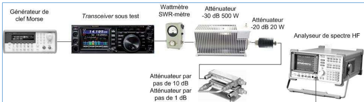
Fig. 92 : Setup de test pour l'analyse spectrale radiofréquence d'une émission en télégraphie. Graphisme : ON4IJ.
