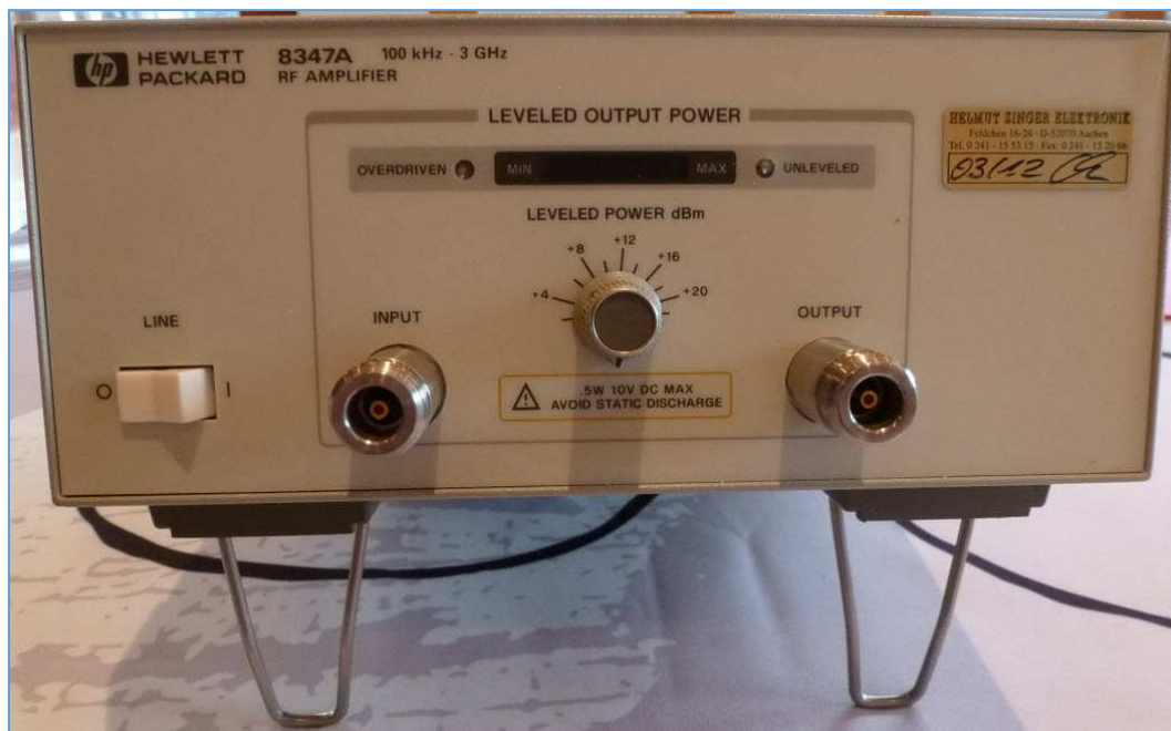
Fig. 20 : Exemple d'un amplificateur large bande de 100 kHz à 3 GHz (HP 8347A) pouvant être suivi d'un atténuateur de façon à créer un dispositif isolateur HF à large bande pour améliorer le rapport de protection entre deux générateurs HF et les ports d'entrées d'un coupleur hybride. Le gain de cet amplificateur est de +25 dB typique et l'isolation inverse est de 60 dB typique. Photo : ON4IJ.
