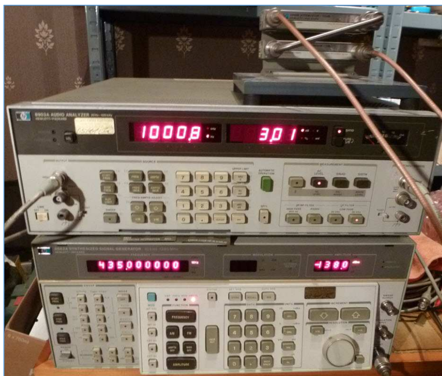
Fig. 8 : Exemple d'un générateur HF (HP 8662A), d'un analyseur audio distorsiomètre (HP 8903A) et (au-dessus à droite) d'un atténuateur par pas de 10 dB (HP8496B) et de 1 dB (HP 8494B) pouvant servir aux relevés des mesures de la sensibilité d'un récepteur. Photo : ON4IJ.
