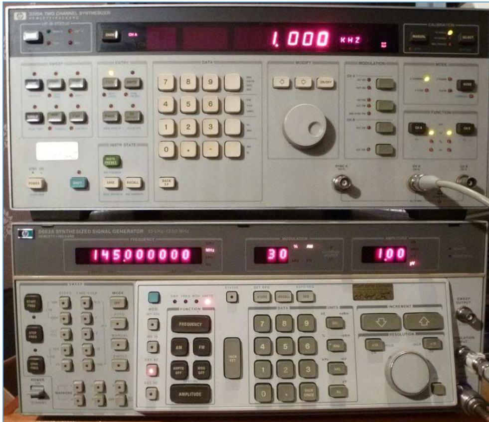
Fig. 44 : Exemple d'un générateur HF (HP 8622A) modulé en AM par un générateur BF externe (HP 3326A) pouvant servir aux relevés de la bande passante des filtres à moyenne fréquence d'un récepteur sous test en mode AM. Remarque : le générateur BF HP 3326A dispose de deux canaux séparés qui peuvent servir pour des mesures avec deux tons sur des fréquences distinctes. Les deux signaux peuvent être combinés sur la même sortie du générateur BF par l'activation d'une fonction prévue à cet effet. Ce générateur deux tons nous sera utile dans la troisième partie pour les tests d'un émetteur en SSB. Photo : ON4IJ.
