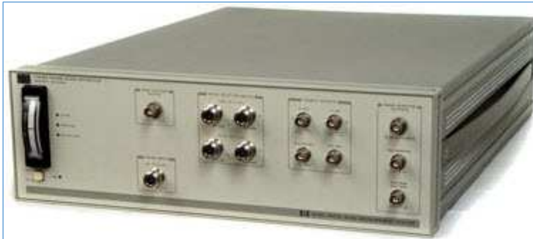
Fig. 99 : Détecteur de phase, Phase Noise Interface HP 11848A utilisé par l'ARRL Lab. Source : Department of Electronics, Carleton University, Ottawa, Ontario, Canada.
