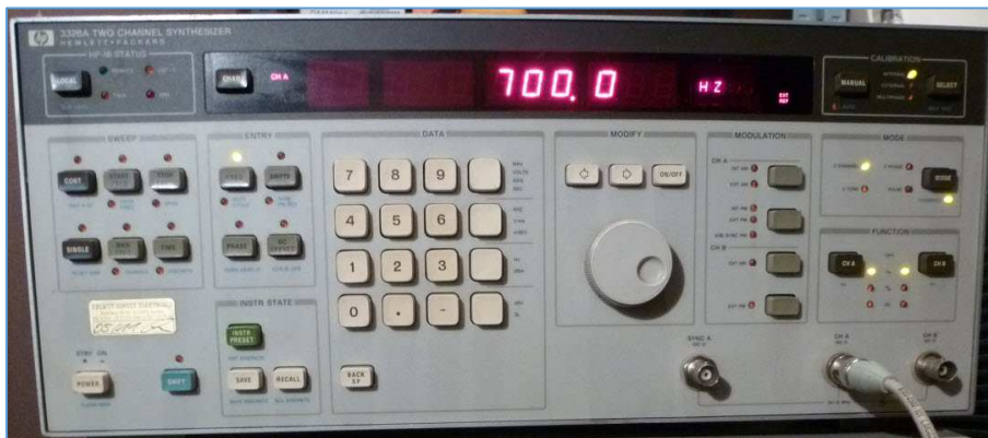
Fig. 65 : Exemple d'un générateur audio à deux canaux pouvant être combinés en interne sur une seule sortie (HP 3326A). Photo : ON4IJ.
