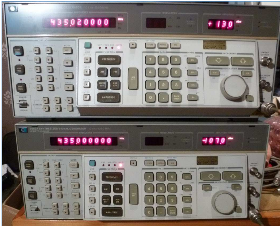
Fig. 12 : Exemple de deux générateurs HF (HP 8662A) pour le Setup de mesure de la gamme dynamique de compression de gain d'un transceiver UHF. En dessous, le générateur du signal faible utile d'une amplitude de -107 dBm sur 435,000 MHz et au-dessus, le générateur du signal fort non désiré d'une amplitude de +13 dBm sur 435,020 MHz à 20 kHz d'écart. Comme les signaux sont combinés par un coupleur hybride dont la perte d'insertion est de -3 dB, le signal faible sera à une valeur standard de -110 dBm à l'entrée du récepteur et le signal fort à +10 dBm. Pour un récepteur dont la sensibilité est de -127 dBm, la gamme dynamique de compression est donc ici de : +10 \text{ dBm} - (-127 \text{ dBm}) = 137 \text{ dB} . Photo : ON4IJ.
