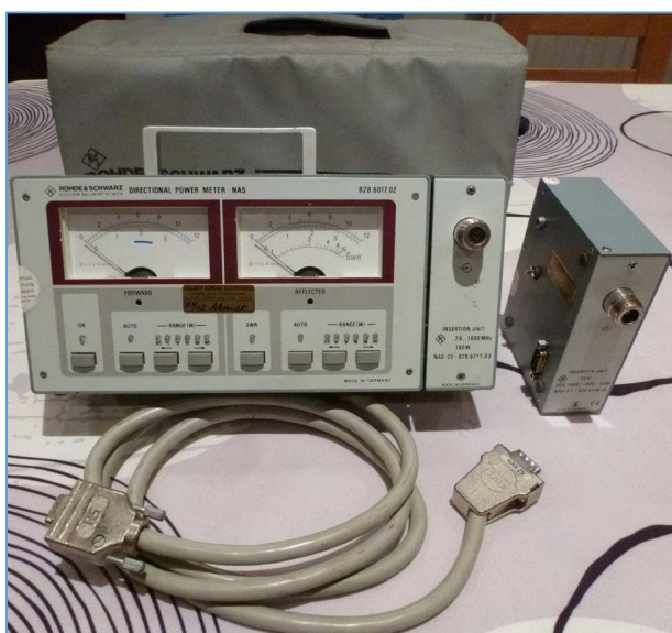
Fig. 64 : Exemple d'un wattmètre/SWR-mètre (Rohde et Schwarz NAS) pour la mesure de la puissance de sortie HF d'un émetteur. Le coupleur directionnel est externe et peut soit être accolé à l'appareil de mesure, soit être relié par l'intermédiaire d'un câble pour permettre plus de liberté de mouvements lors des raccordements des câbles coaxiaux sur les connecteurs du coupleur directionnel. Sur la droite, un deuxième coupleur pour une autre gamme d'ondes ; à l'avant plan le câble de raccordement entre le coupleur et l'appareil de mesure ; à l'arrière-plan une sacoche pour le transport facile de l'instrument de mesure. Photo : ON4IJ.
