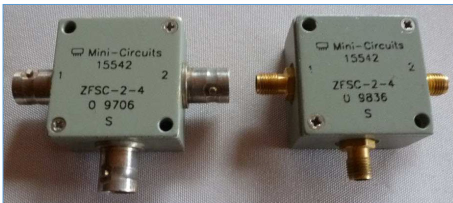
Fig. 13 : Exemples de coupleurs hybrides Mini-Circuits ZFSC-2-4, bande passante de 200 kHz à 1000 MHz, perte d'insertion typique -3 dB, isolation typique 30 dB. À gauche un modèle équipé de connecteurs BNC et à droite un modèle équipé de connecteurs SMA. Photo : ON4IJ.
