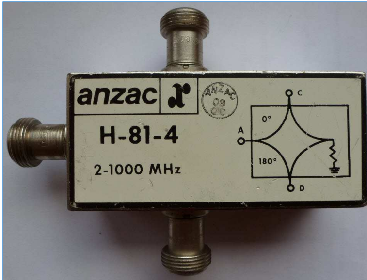
Fig. 22 : Exemple d'un coupleur hybride large bande de 2 MHz à 1000 MHz équipé de connecteurs type N (Anzac Ma/Com H-81-4 #8063) et prévu pour des signaux forts (2 W max.), dont la perte d'insertion typique est relativement faible de 0,7 dB à 1,3 dB et dont l'isolation typique est de 20 dB à 25 dB. Remarque : ce diviseur de puissance peut être utilisé d'une manière réversible comme sommateur de signaux ; les ports d'entrées sont alors C et D et le port de sortie est A. Photo : ON4IJ.
