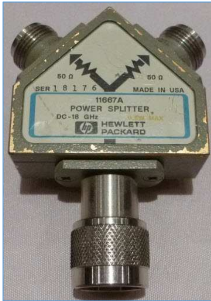
Fig. 53 : Exemple d'un séparateur de signaux ( Power Splitter ) (HP 11667A) pouvant servir au setup de test de la figure 51. Photo : ON4IJ.
