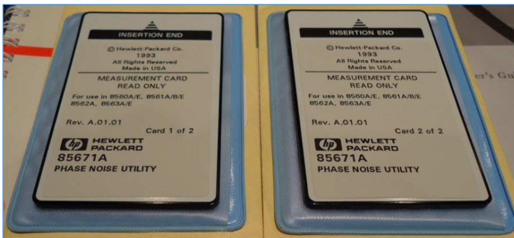
Fig. 101 : Cartes mémoires du logiciel HP 85671A Phase Noise Utility utilisé sur l'analyseur de spectre HP 8563E (voir figures 15 et 23) ayant servi à relever le bruit de phase de quelques émetteurs, voir illustrations des figures suivantes. Photo : ON4IJ.
