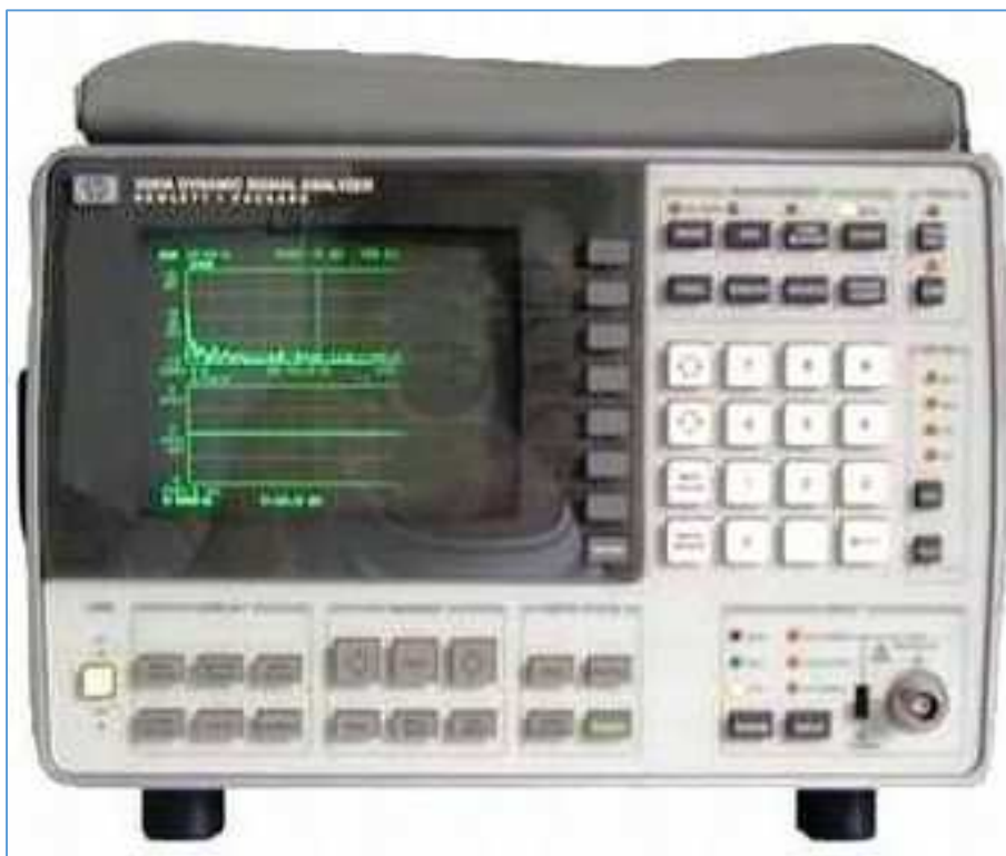
Fig. 11 : Exemple d'analyseur de signaux, analyseur de spectre BF (HP 3561A) pour mesurer la chute de 1 dB du signal audio à la sortie d'un récepteur. Source : Alliance Test Equipment.
