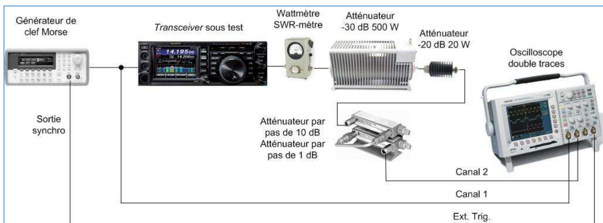
Fig. 91 : Setup de test pour l'analyse dans le domaine du temps des formes d'ondes transmises par un émetteur en télégraphie. Graphisme : ON4IJ.
