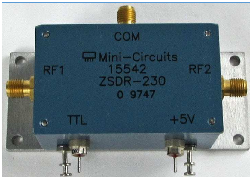
Fig. 55 : Exemple d'un commutateur à diodes PIN (Mini-Circuit ZSDR-230) pouvant servir au Setup de test de la figure 51. Source : Ebay electro-mavin.
