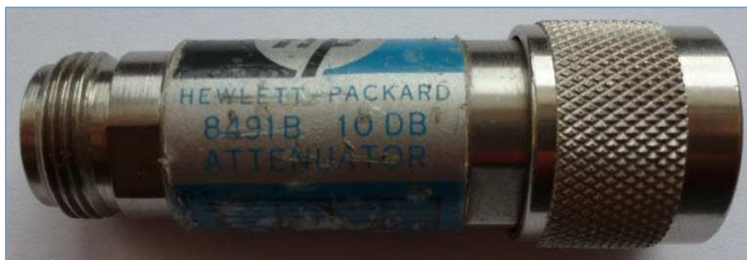
Fig. 21 : Exemple d'un atténuateur fixe de -10 dB (HP 8491B) pouvant être raccordé entre la sortie de l'amplificateur large bande et l'entrée du coupleur hybride. Photo : ON4IJ.
